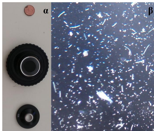
Εικόνα 3. α: Τοποθέτηση μαύρου δίσκου μεγέθους ενός λεπτού του ευρώ στην επιφάνεια κάτω από το συγκεντρωτή. β: Εικόνα μικροβίων με μικροσκοπία σκοτεινού πεδίου.
