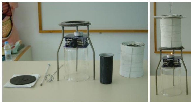
Εικόνα 4. Κατασκευή θερμιδόμετρου με το μαύρο δοχείο μέτρησης της απορρόφησης ακτινοβολίας, κουτί από καφέ, σύρμα για ανάδευση και μονωτικό υλικό.
